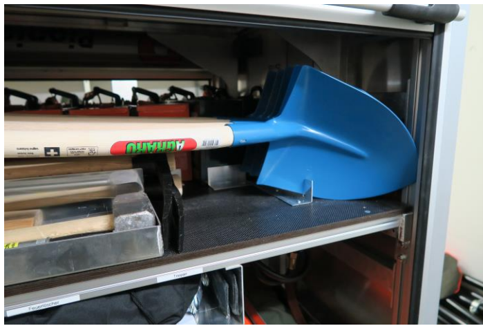
Bild 5: Modifikation für den Transport von fünf Schaufeln
